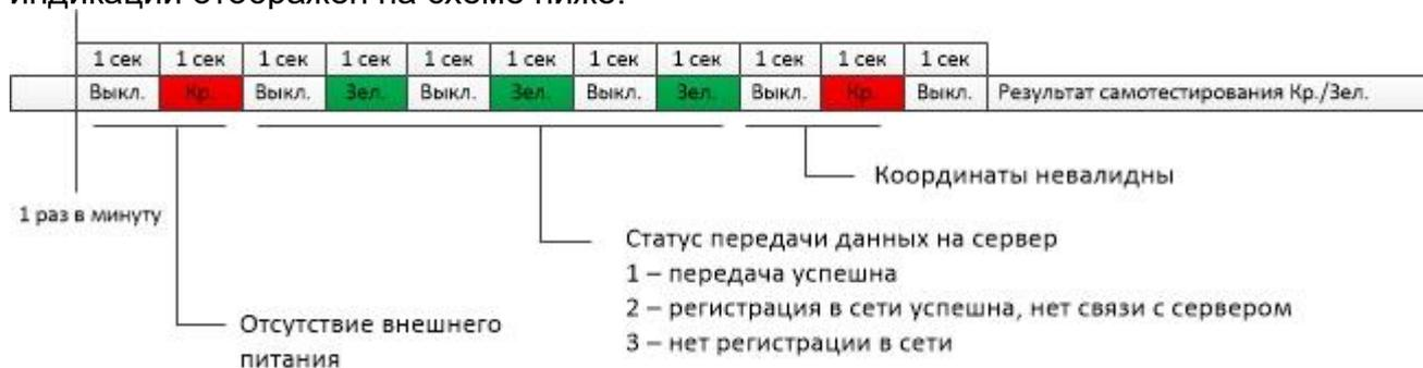
Стандартное состояние светодиода зависит от результата самотестирования устройства (горит красным, если выявлена неисправность, не горит – если неисправность не выявлена). Раз в минуту индикатор последовательно отображает статус внешнего питания, передачи данных на сервер и валидности (захвата) координат местоположения.
